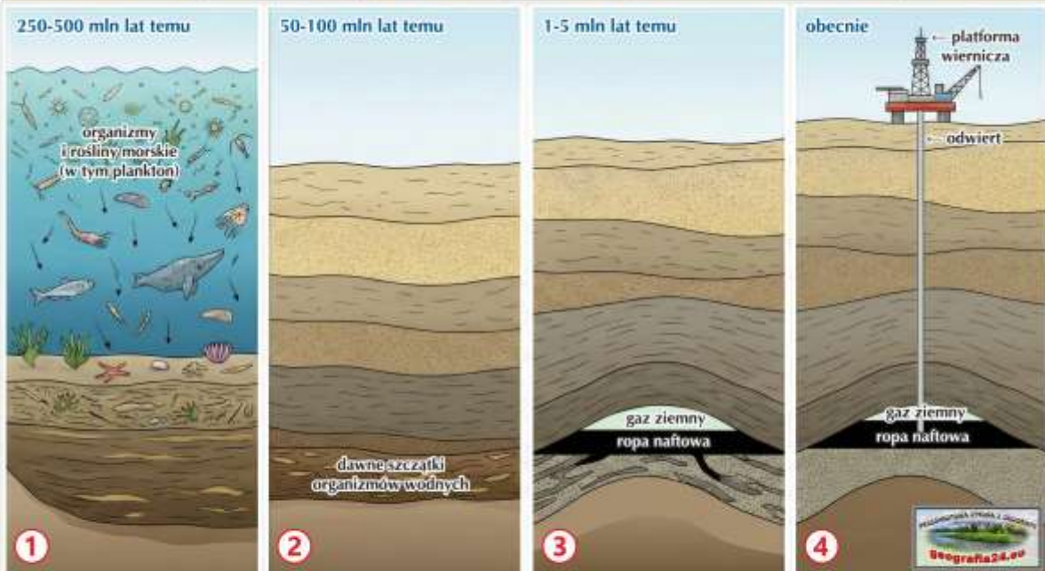
Proces powstawania ropy naftowej i gazu ziemnego w środowisku beztlenowym
